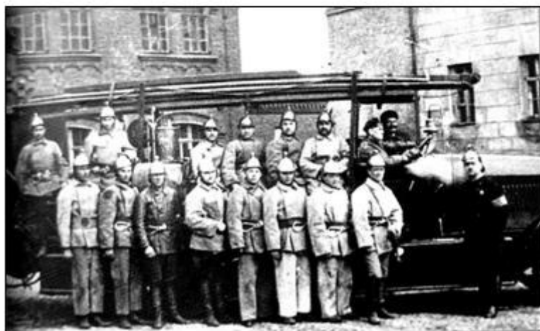
В 1932 г. пожарная часть г. Барнаула получила первый автомобиль АМО-Ф-15, который переоборудовали под пожарную автоцистерну емкостью 800 литров воды. Машина могла сама подавать воду к месту пожара. Фото из книги «Летопись пожарной охраны Алтайского края».
